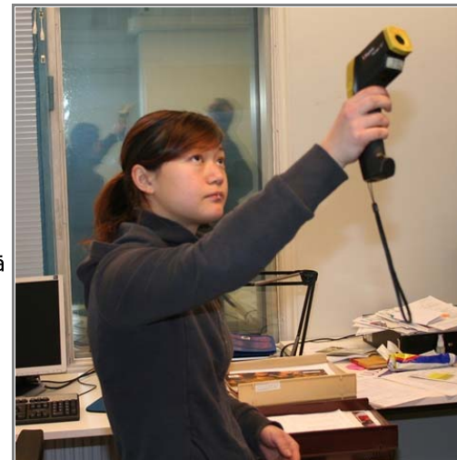
Sonja Toivanen mittaa mm. seinien, lattian ja lämpöverkoston putkien pintalämpötilat. Lisäksi mitataan tilan yleinen lämpötila. Nämä tiedot auttavat asiantuntijaa sisäolojen ymmärtämisessä.
